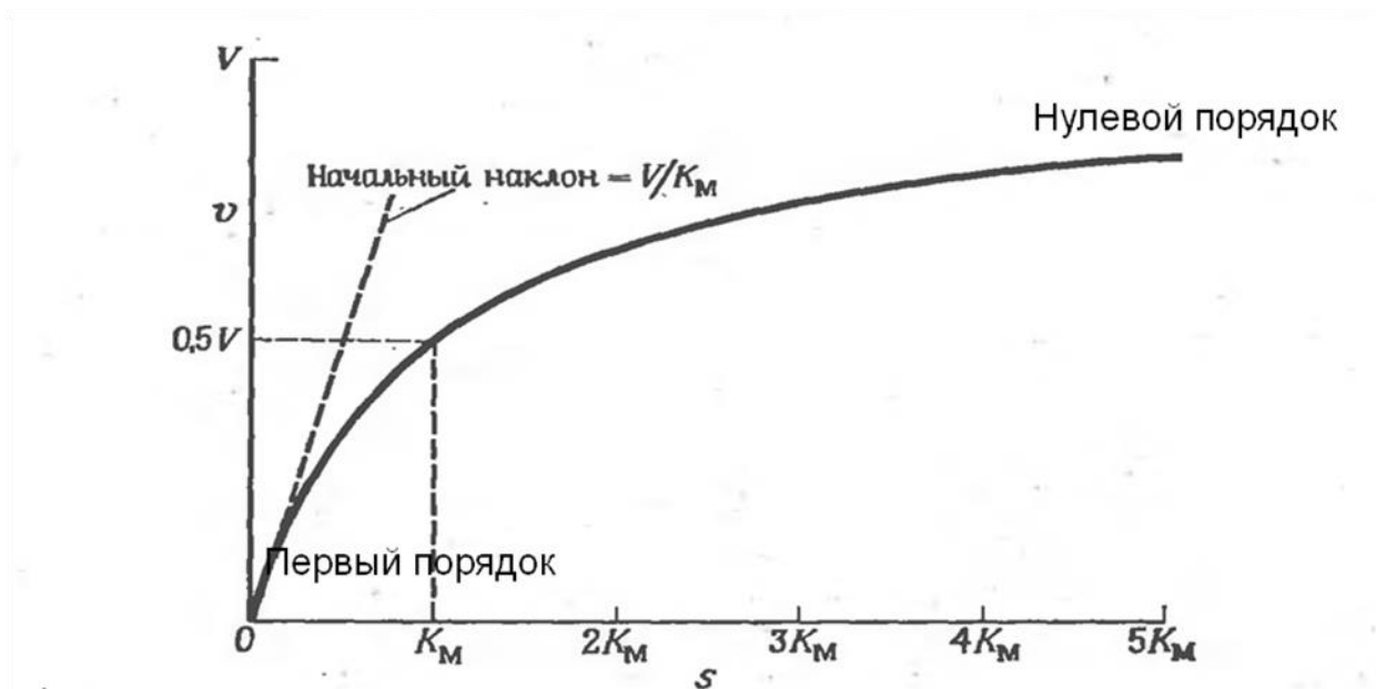
Рис. 2.1. График зависимости начальной скорости v от концентрации субстрата s для реакции, подчиняющейся уравнению Михаэлиса — Ментен. (Михаэлис и Ментен этот график не использовали и предложенный применять его не давали.)
