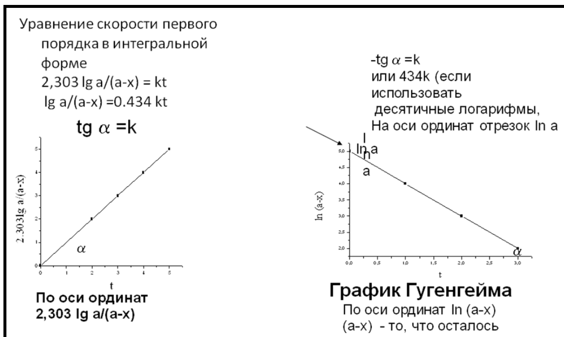
Рис.10 Кинетические графики для реакции первого порядка в полулогарифмических координатах
